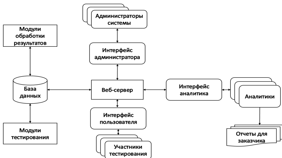
Рисунок 25. Схема реализации компьютерной системы диагностики отношения к предметам
