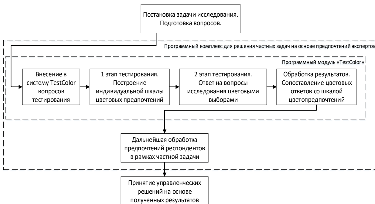
Рисунок 34. Схема применения программного модуля «TestColor» при решении частных задач на основе предпочтений экспертов
