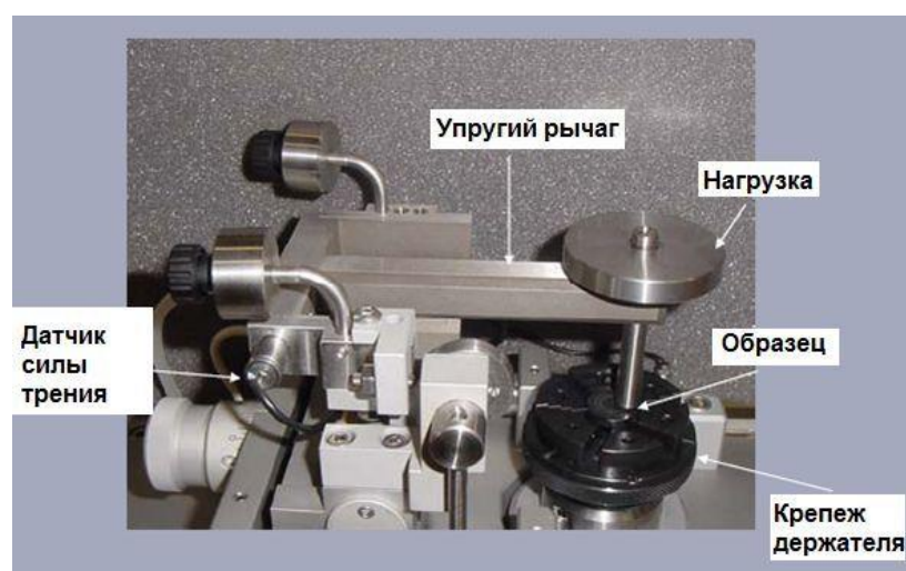
Рисунок 2.29 – Схема автоматизированной машины трения (Tribometer, CSM Instruments, Швейцария)
