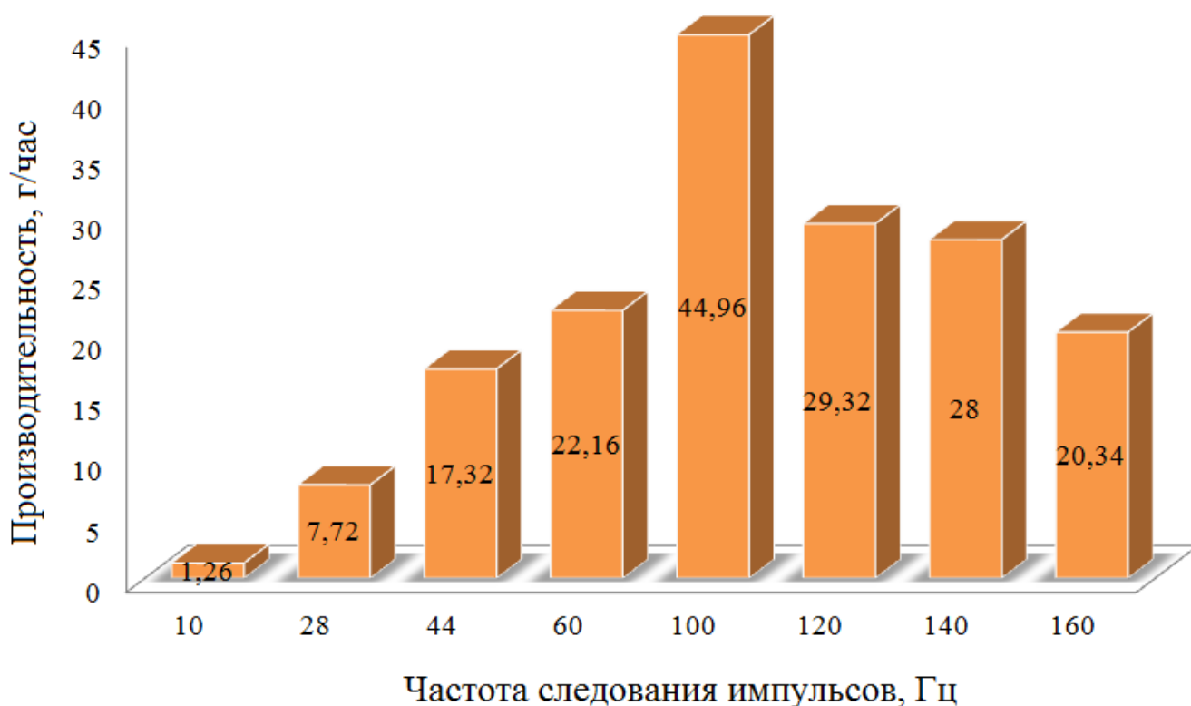
Рисунок 3.4 – Зависимость производительности процесса электроэрозионного диспергирования меди в дистиллированной воде от частоты следования импульсов при U=220 В
