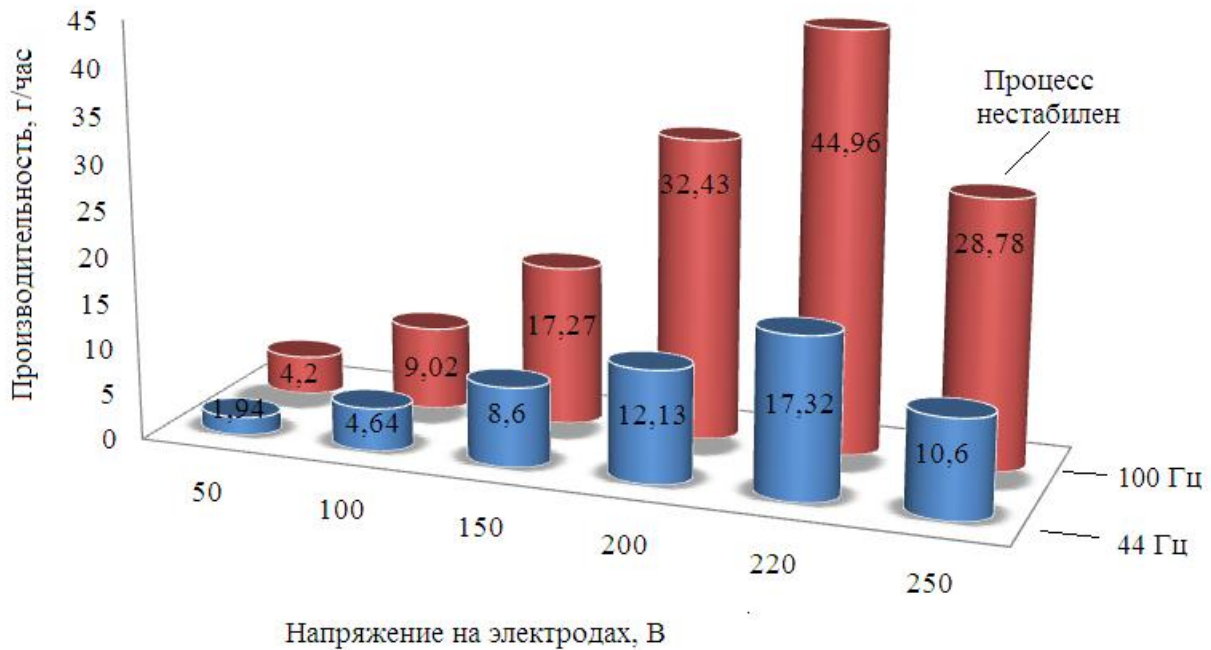
Рисунок 3.2 – Зависимость производительности процесса электроэрозионного диспергирования меди в дистиллированной воде от напряжения на электродах
