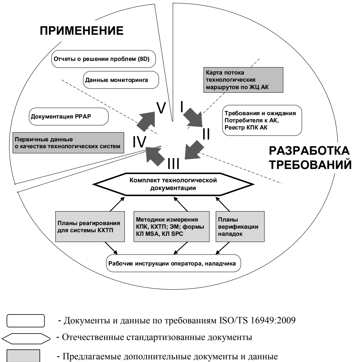
Рисунок 3.8 – Документооборот информационно-технологического сопровождения качества автокомпонентов в цикле APQP-проекта (ЖЦ – жизненный цикл; КПК – ключевой показателей качества; КХТП – контрольные характеристики технологических переходов; ЭМ – эмпирические модели процессов; КЛ – контрольные листы, АК – автокомпонент)
